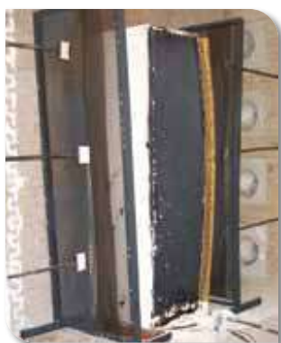
Armadio CHEMISAFE FIRE MY11 DOPO il test di resistenza al fuoco.
